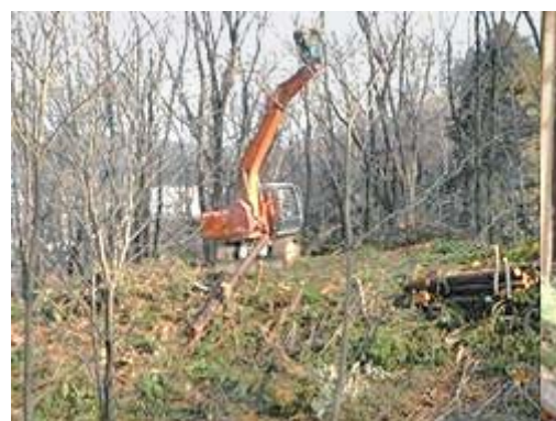
スイングヤーダ (旋回ブーム式タワー付集材機)
