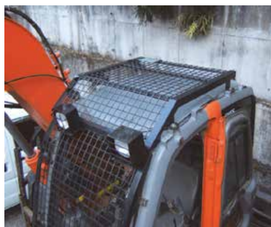
車両系木材伐出機械（前面保護柵、上部保護柵）
