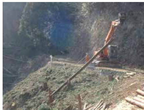
スイングヤーダ (旋回ブーム式タワー付集材機)
