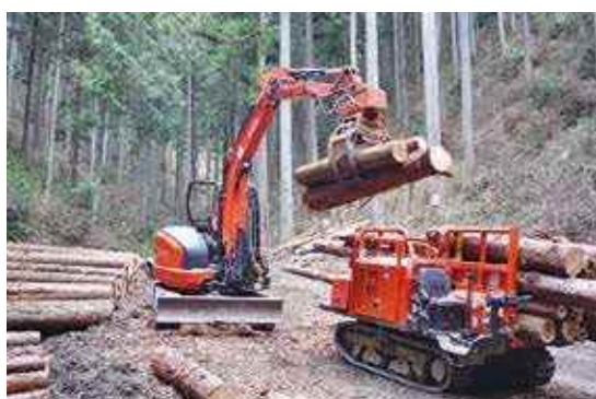
間伐材搬出(小型機械により搬出される木材)
