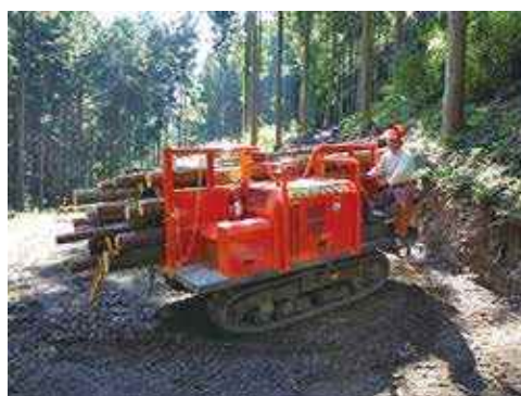
間伐材搬出(作業道を使って搬出される木材)
