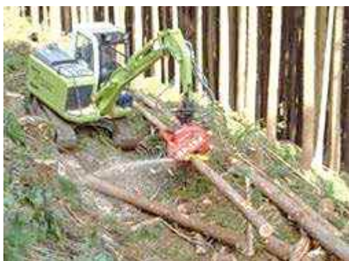
プロセッサ (枝払い・玉切り・集積機能付き造材機)
